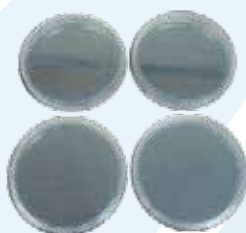
Figura 2 - Fotos dos resultados das avaliações da eficácia de biocidas incorporados a corpos de prova com o produto sem a formação de UFC (pontos brancos)
