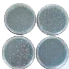
Figura 1 - Fotos dos resultados da incubação dos corpos de prova sem o produto mostram a formação de UFC (pontos brancos)
